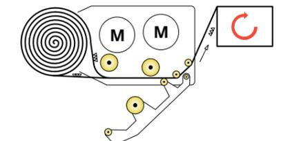
**IT.** Sistema di prestiro motorizzato a 3 rulli con 2 motori e variazione continua da 120 a 350% regolabile da quadro comandi.
