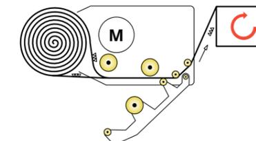
**IT.** Sistema di prestiro motorizzato a 3 rulli comandato elettronicamente con rapporti intercambiabili: 150 - 200 - 250%.
