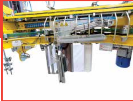
IT_ Sistema saldatura del film estensibile autoregolante per qualsiasi dimensione del pallet.
