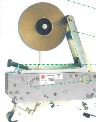
Las características técnicas de nuestros cabezales de precinto nos ponen constantemente a la vanguardia. Los cabezales de precinto superior e inferior de COMARME son intercambiables en cualquier modelo de máquina. El montaje y sustitución de los cabezales es simple y no es necesario el uso de utensilios.
